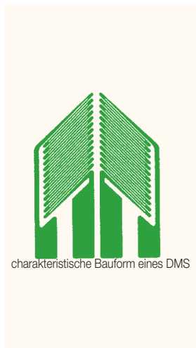
Funktionsprinzip unserer Dehnmessstreifen Aufnahme
