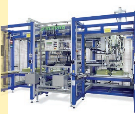
Montaje de tornillos de rejilla radiadora
